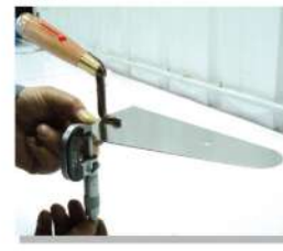
contrôle épaisseur lame
