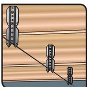
3. Aligner les suspentes grâce à l'encoche prévue à cet effet, conformément aux dimensions des plaques de plâtre et au sens de l'ossature
