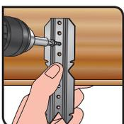
2. Fixer les suspentes avec 2 vis en bordure de charpente, perpendiculairement au chevron
