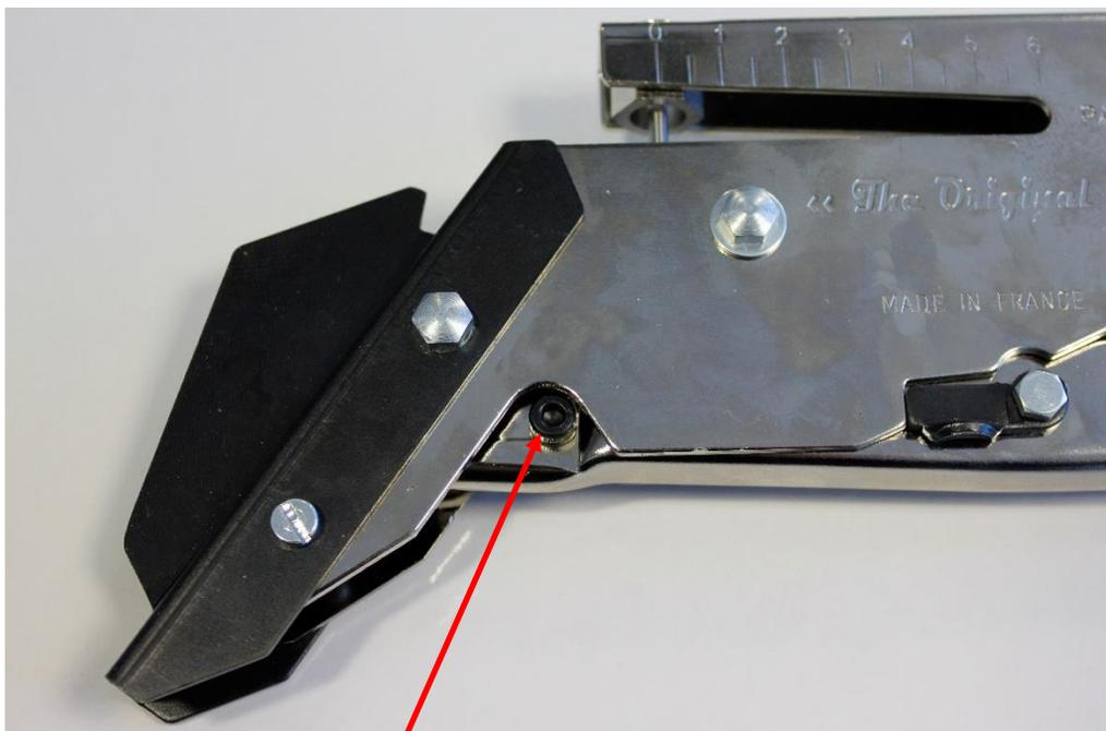
**Le système de fixation de la lame est différent et se distingue rapidement grâce à l'ajout de cet écrou, pas présent sur l'ancienne version.**
