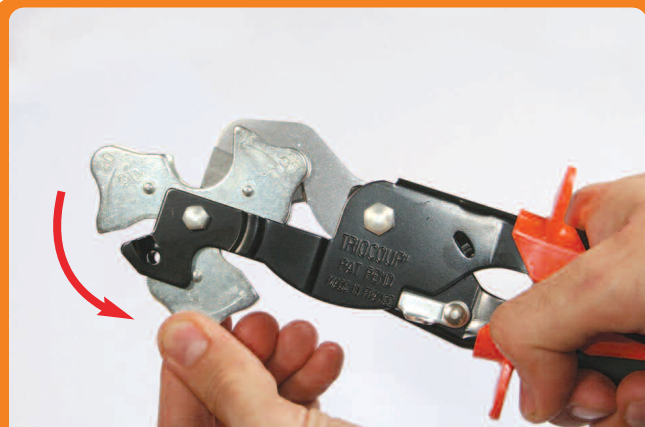
pincer pour faire pivoter la platine revolver
