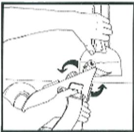
**Lorsque vous êtes prêt à couper,** placer un couteau fermement sur la bande. Utilisez un mouvement de torsion rapide vers le haut contre le couteau afin de produire une coupe nette. Vous devrez peut-être essayer sur quelques bandes courtes pour acquérir la technique. Un cutter peut aussi être utilisé. Toujours laisser environ 5 cm de bande entre les roues dentées et la coupe.
