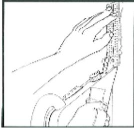
**Votre main doit être bien ajustée sous la sangle.** Ajuster la sangle latérale en desserrant les vis. Pour commencer, tenir le bout de la bande au sommet de l'endroit désiré. Une fois démarré, la distribution se fera automatiquement avec l'aide des roulettes.
