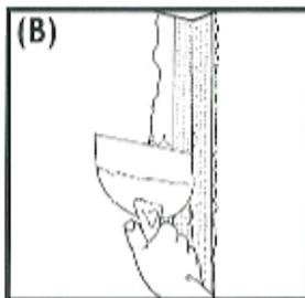
**Utilisez un couteau américain** ou de finition ou une truelle d'angle pour appuyer sur bande dans l'angle (A)
