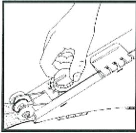
**Régler l'épaisseur d'enduit.** Tournez le bouton de contrôle d'applicateur d'enduit à l'épaisseur désirée. Il est recommandé de commencer avec un réglage entre 2-3.
